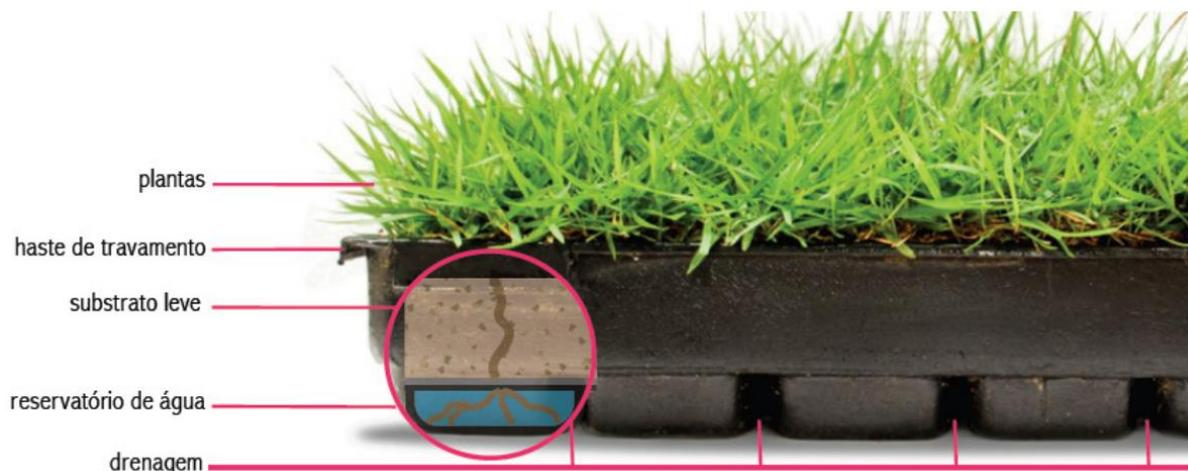
Figura 8 - Detalhamento do sistema Flat 17L
